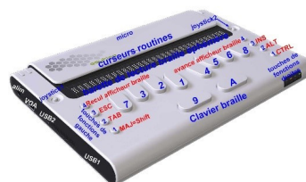
Illustration 22: L'ordinateur braille ESYTIME d'Eurobraille
